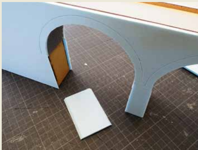
Besondere Beachtung gilt sauberen Gehrungsschnitten an den Pfeilern.
